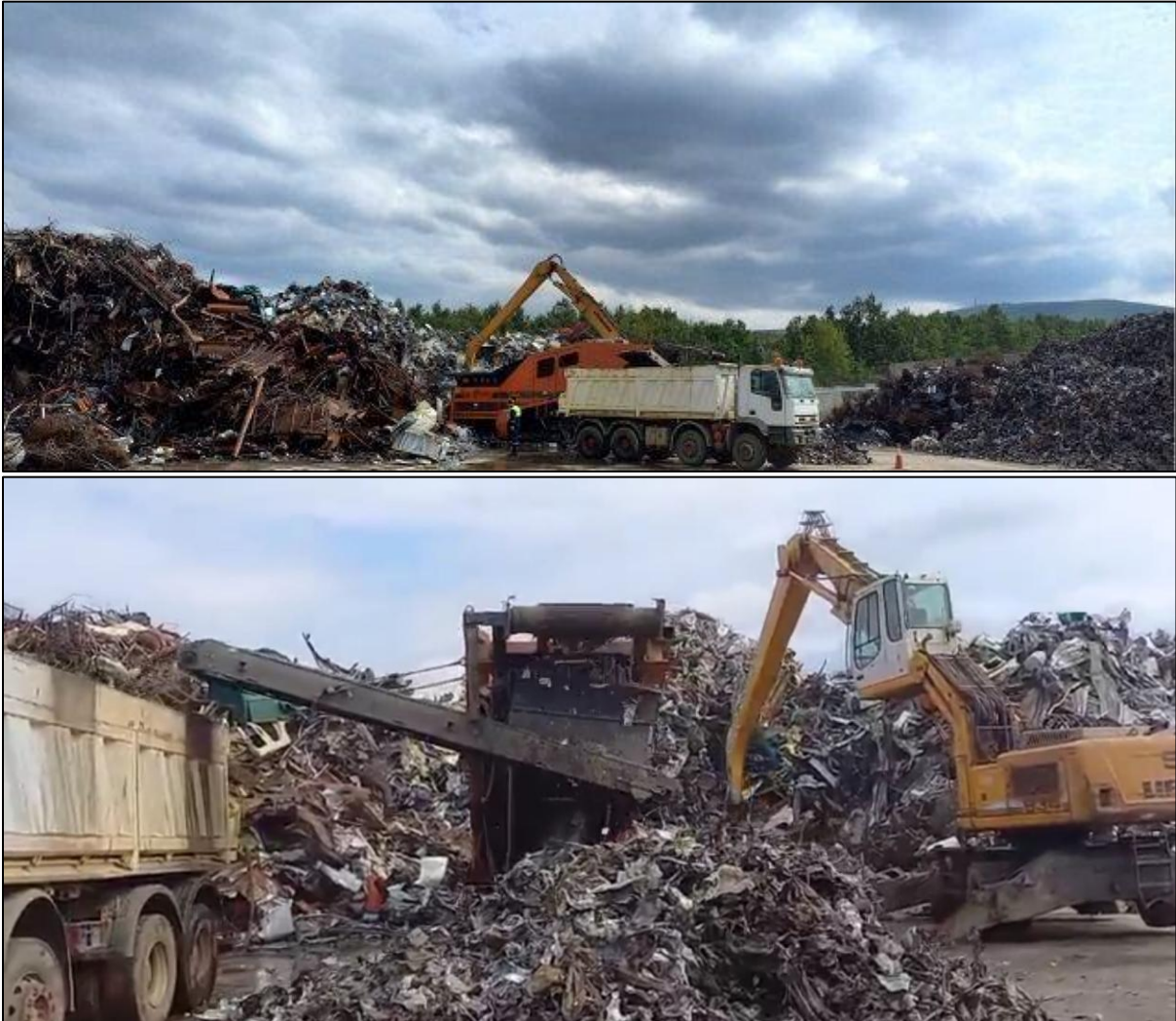
Figura 11. Procesi i punës se presës për prerjen e metaleve
