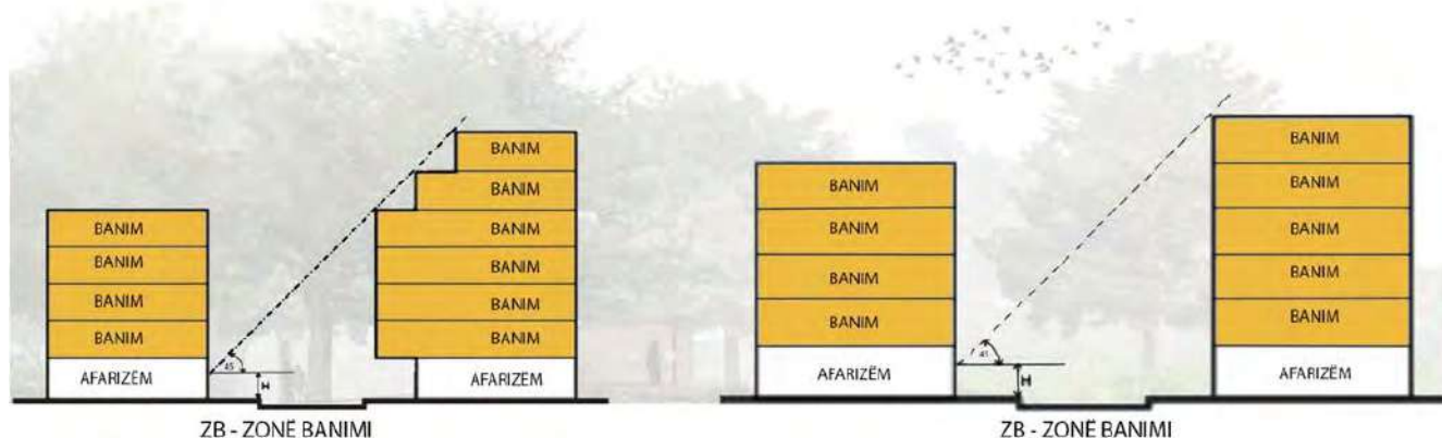
Figura 11 Shembulli i llogaritjes së lartësisë për bazuar në këndin 45°
