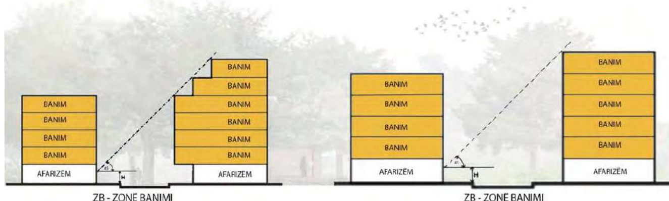
Figura 12 Shembulli i llogaritjes së lartësisë për bazuar në këndin 45°
