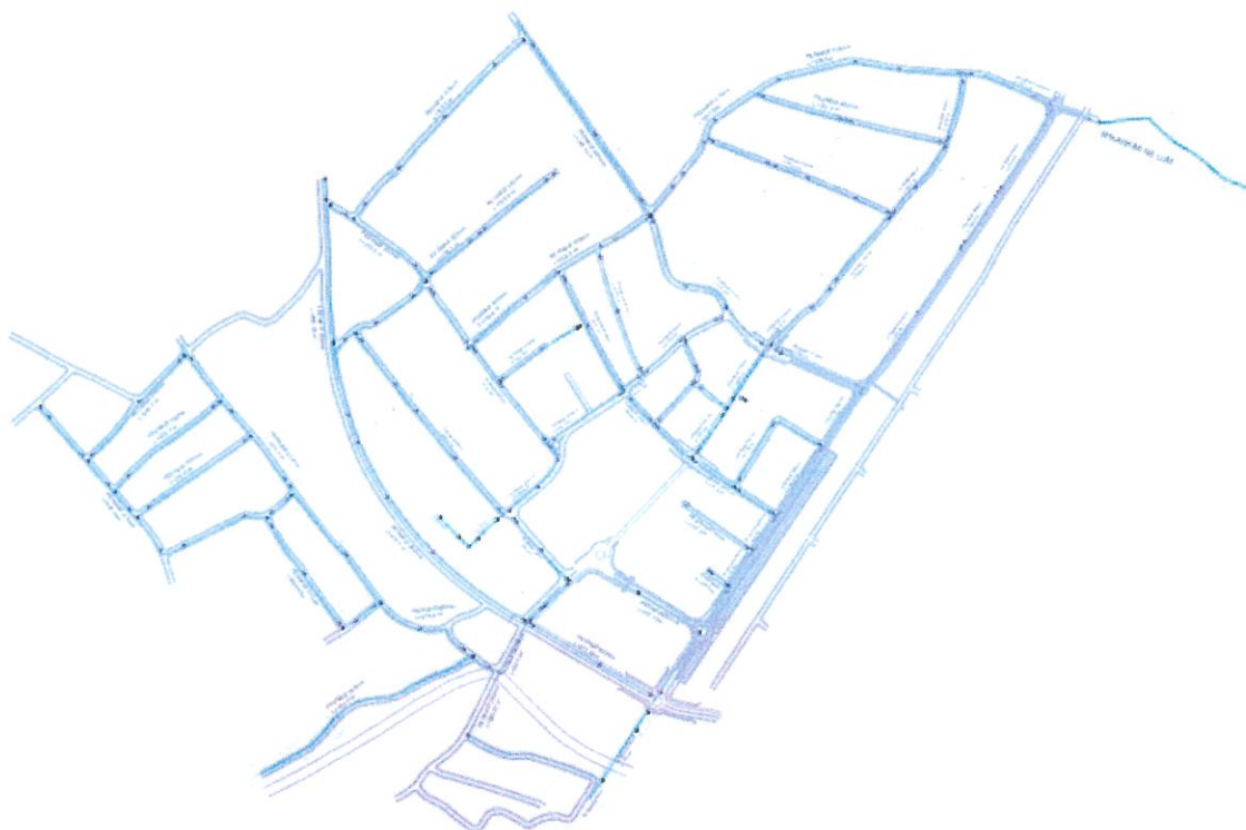
Figura 16 Rrjeta e kanalizimit të ujërave atmosferike
